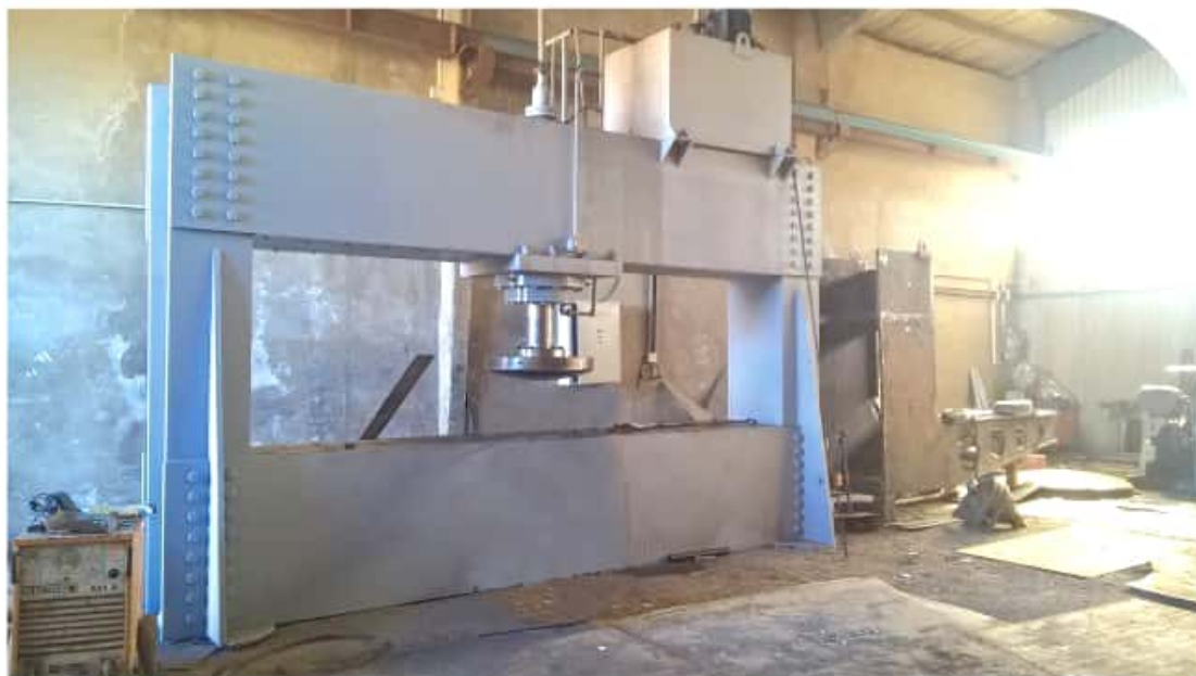
دستگاه پرس ۷۵۰ تن با قابلیت ساخت عدسی تا قطر ۵ متر و ضخامت ۴۰ میلی متر
