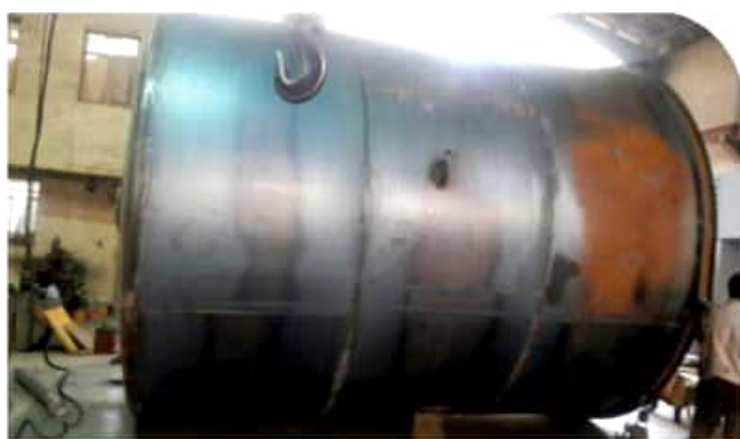
مخزن استوانه ای در حال ساخت
